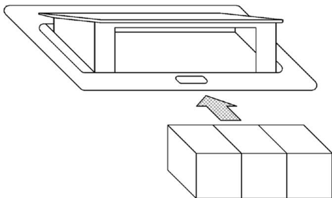
6. Установить панель на монтажную коробку и зафиксировать ее, используя крепежный комплект
