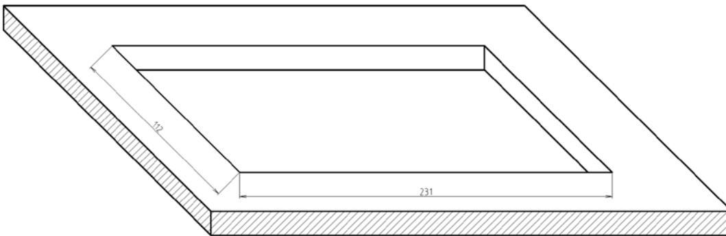
2. Установить монтажную коробку в отверстие и зафиксировать её, используя крепежный комплект.
