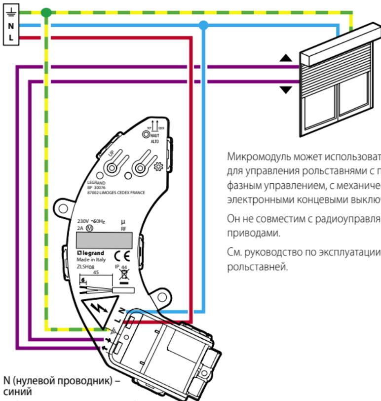
Микромодуль может использоваться для управления рольставнями с прямым фазным управлением, с механическими или электронными концевыми выключателями.
