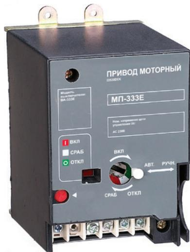
Аксессуар предназначен для дистанционного включения и отключения автоматических выключателей серии ВА-330Е.
