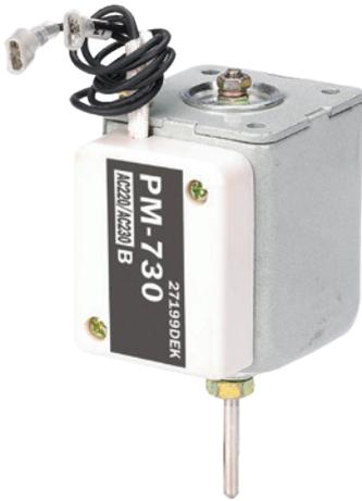
Аксессуар, который служит для отключения автоматического выключателя при снижении напряжения ниже минимального значения. Когда автоматический выключатель включен и его напряжение падает до 70–35 % от номинального напряжения, он может отключиться посредством активации расцепителя. Автоматический выключатель может быть снова замкнут только тогда, когда напряжение питания катушки расцепителя минимального напряжения восстановится до 85 % от номинального напряжения.
