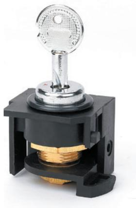
Когда автоматический выключатель находится в отсоединенном положении, его можно заблокировать от включения с помощью замка с ключом. В этом случае автоматический выключатель может быть включен только тогда, когда замок открыт ключом и ключ не вынут из замочной скважины. Существует три варианта такого способа блокировки (последние два используются в распределительной системе с двумя линиями и одним соединительным интерфейсом): один замок, один ключ; два замка, один ключ; три замка, два ключа.
