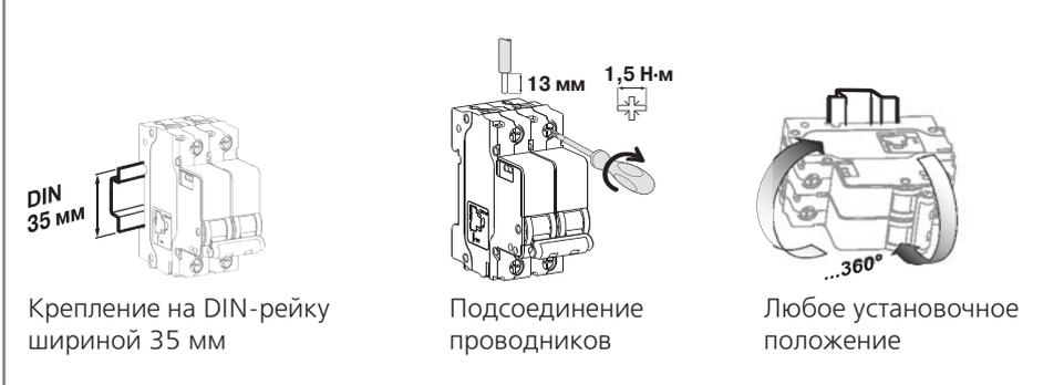
Крепление на DIN-рейку шириной 35 мм
