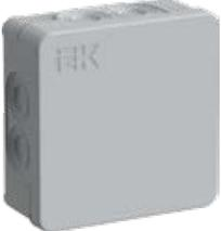
Коробка расп. КМ для п/м 100×100×40 мм IP65 8 вв. (7035) IEK | 100×100×40                  | 8                      | Кабельные вводы D = 20мм | Полипропилен, термоэластопласт (ТЭП) | Серый (RAL 7035)  | UKO10-100-100-040-K41-65 |
