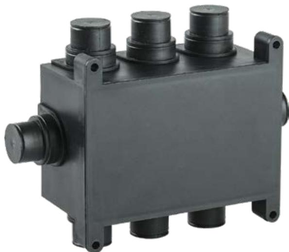
Применяются для заливки в бетон при организации разветвления проводов и кабелей, а также для дополнительной защиты мест коммутации при монолитном бетоностроении. Используются в комплексе с электротехническими (гофрированными, гладкими, армированными) трубами. Коробки замоноличиваются крышкой наружу.
