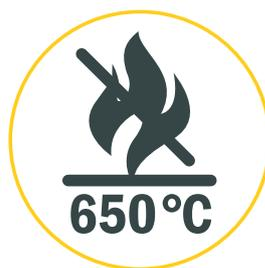
Коробки выдерживают испытание раскаленной до +650 °C проволокой и не загорятся при соприкосновении в течение 30 секунд
