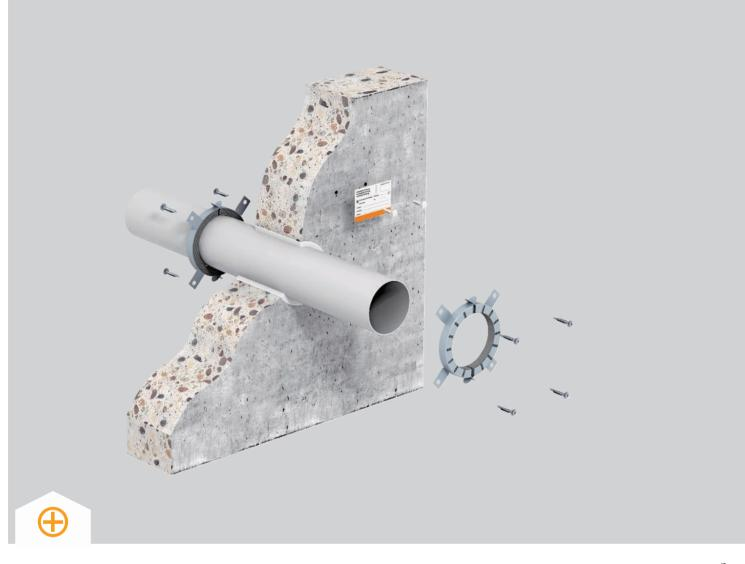
Система PYROCOMB® может использоваться для прокладки труб из горючих материалов (например, санитарно-технических). Система представлена в первую очередь манжетами типа ТСХ. Проложенный внутри манжеты огнезащитный материал вспенивается через несколько минут после начала пожара и, образуя высокое давление,сжимает ставшие мягкими пластиковые трубы. Это надежно предотвращает
