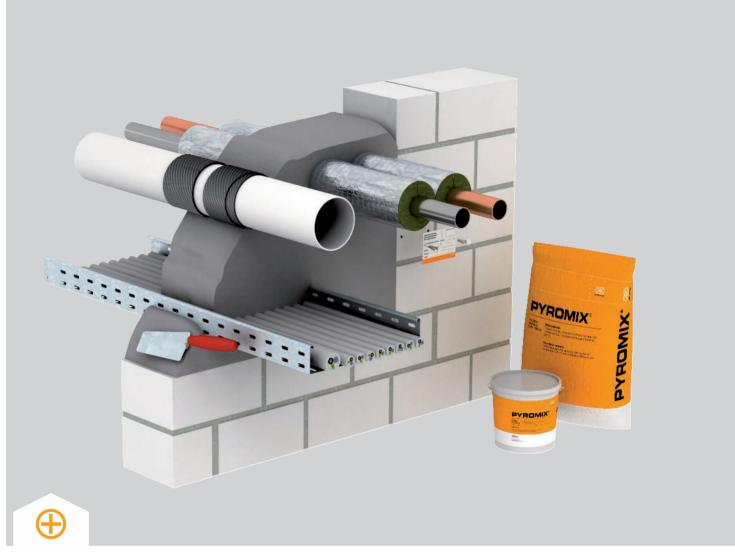
РҮКОМІХ® - это специальный, не содержащий минеральных волокон, раствор для огнестойких кабельных и комбинированных проходок. В зависимости от количества добавляемой воды, готовая масса может устанавливаться вручную или с помощью помпы и пресса. За счет высоких показателей адгезии к различным базовым
