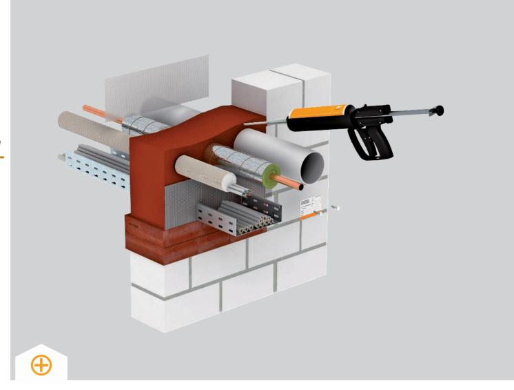
С помощью системы PYROSIT® NG от ОБО создаются кабельные комбинированные И проходки из огнестойкой пены. Особая рецептура 2-компонентной смеси обеспечивает простую и «точечнуюную» проработку. Высокие показатели адгезии со всеми материаламиобеспечивают идеальное сцеплениепены в проходке. При работе двухкомпонентной пеной возможны кратковременные перерывы в работе засчет поставки в комплекте 2 смесительных трубок. Монтаж системы без ПЫЛИ И волокон, дополнительное покрытие поверхности
