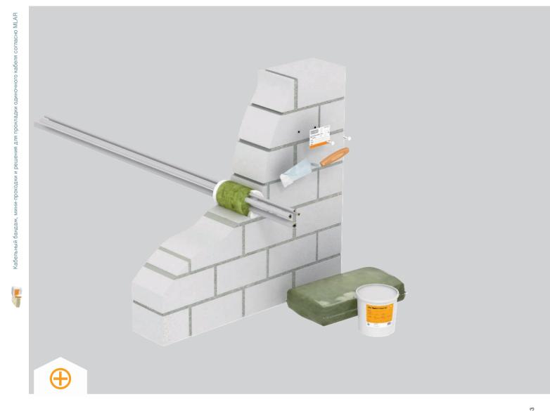
Благодаря системе PYROMIX® Screed можно создать небольшую огнестойкую кабельную проходку. Система состоит из материала, образующего изоляционный слой, и минеральной ваты. Негорючая минеральная вата имеет точку плавления  $\geq 1000~^{\circ}$ С и служит основой кабельной проходки. Затем обе стороны отверстия
