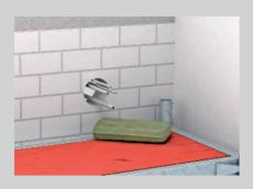
Минеральная вата с точкой плавления ≥ 1000 °C для заполнения отверстия.
