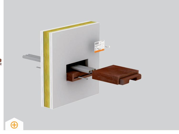
С помощью системы PYROPLUG® Box от ОВО создаются кабельные проходки с рамками из пеноматериала. Данная система особенно подходит для монтажа кабельных проходок в легких разделительных перегородках. Дополнительной подготовки внутренней поверхности отверстия не требуется; Кроме того, допускается их монтаж в монолитных стенах. Система огнестойких проходок состоит из разделенной на две части рамки двух соответствующих внутренних блоков. В случае
