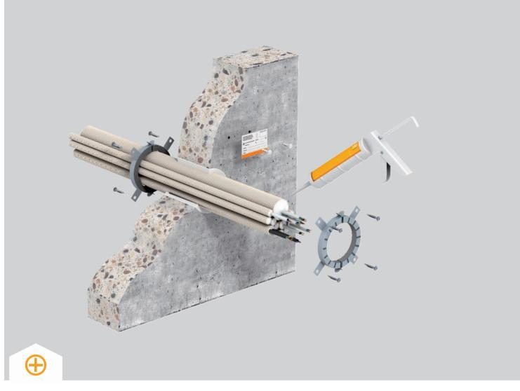
Система PYROCOMB® Tubes создает кабельные проходки с помощью манжет для труб. Система включает в себя манжеты типа TCX нескольких размеров. Таким образом, можно легко изолировать пучки пластиковых электромонтажныхтруб, неподвижных или гибких. Максимальный размер труб в пучке M63. При этом неважно, проложены в трубах кабели или нет.
