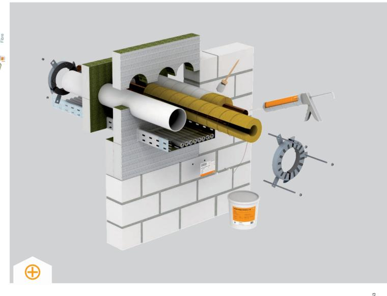
РҮКОРLATE® Fibre - это проходка от ОБО Беттерманн на основе панели из каменной ваты. Центральный элемент системы - панель из минерального волокна, предварительно покрытая влагостойким абляционным защитным слоем. При пожаре огнестойкое покрытие образует изолирующую пену. Эта пена вместе с панелями из минерального волокна препятствует распространению огня и дыма. Наряду с кабелем и проводами через проходку одновременно можно
