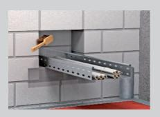
Очистить внутреннюю поверхность отверстия конструктивного элемента и закрепить на нейвспомогательную опалубку, например, клейкую ленту.
