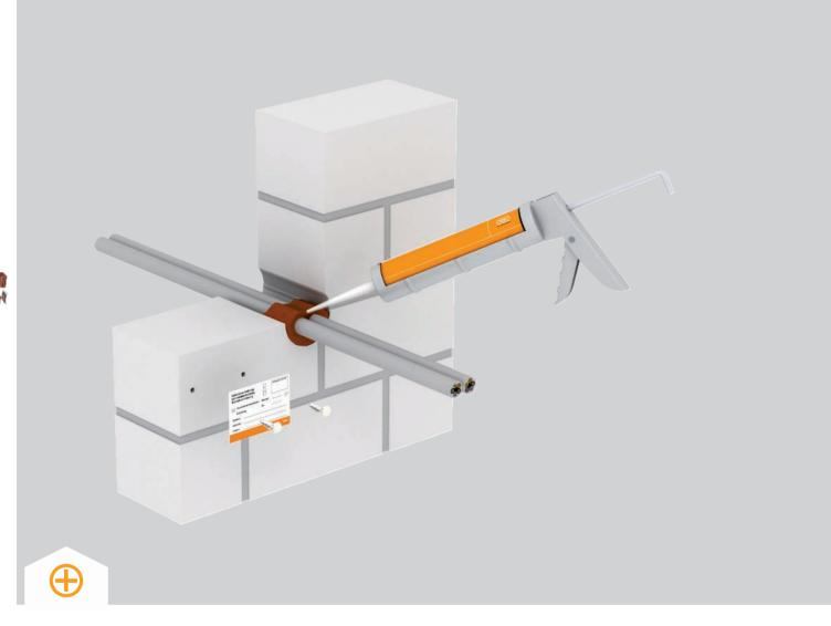
Система PYROPLUG® Mini от ОБО Беттерманн является идеальным решением для монтажа маленьких, круглых кабельных проходок диаметром до 8 см. Она состоит из однокомпонентной шпатлевкиРYROPLUG® Screed. В легких перегородках также используется пустая
