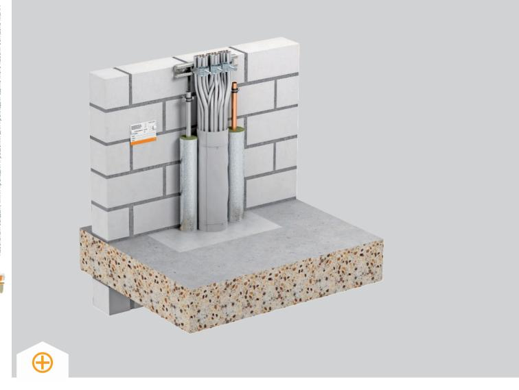
Система Conlit®, состоящая из огнестойкого бандажа типа CL-KS, применяется внутри зданий в качестве кабельной проходки для отдельных кабелей и электромонтажных труб (EIR). Трубы и кабель необходимо обернуть гибким бандажом и зафиксировать проволокой. Кабельные пучки и жесткие электромонтажные трубы необходимо обернуть бандажом минимум в два слоя, а гибкие
