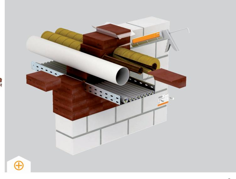
Система комбинированных проходок PYROPLUG® Block от ОБО Беттерманн состоит из огнестойких пеноблоков, которые в случае пожара расширяются без возникновения существенного давления. При этом они образуют изолирующую углеродную пену. Она надежно препятствует распространению огня и дыма через кабельную проходку. Трубы из горючих материалов могут прокладываться через такую проходку без применения дополнительных манжет. Медные и
