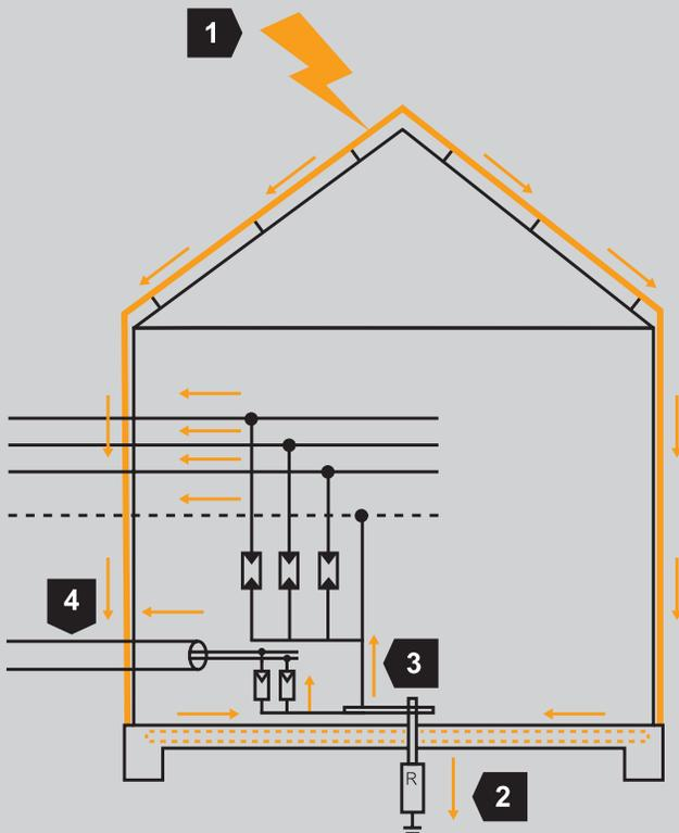
Удары молнии являются источником высоких перенапряжений. В соответствии с ГОСТ Р МЭК 62305 максимальный ток молнии 200 кА (10/350 мкс).
