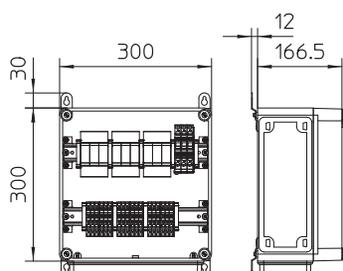
Для защиты постоянного тока преобразователя фотогальванических установок. При опасности образования конденсата вследствие воздействия ветра, снега, температур или солнца необходимо принять дополнительные меры!
