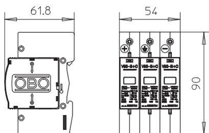
Применение: фотогальванические установки без или с изолированной системой молниезащиты
