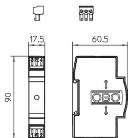
Применение: Универсальное использование на 35мм DIN рейке в стандартном корпусе распределителя.
