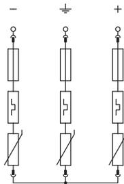
Для защиты постоянного тока преобразователя фотогальванических установок. При опасности образования конденсата вследствие воздействия ветра, снега, температур или солнца необходимо принять дополнительные меры!
