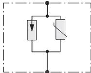
Разрядник FS-V20 является разделительным искровым промежутком с параллельно подключенным устройством для защиты от перенапряжений (уровень защиты <1,5 кВ). Он служит для соединения различных систем заземления.
