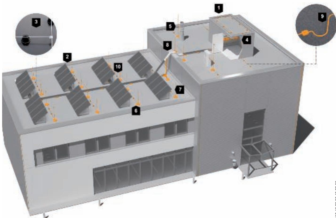
Проектирование и монтаж системы внешней молниезащиты: молниеприемники и токоотводы
