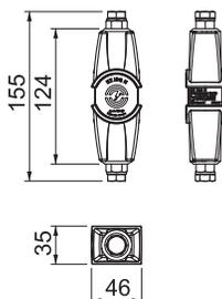
Применение: во взрывоопасных зонах для непрямого соединения изолирующих фланцев и изолирующих винтовых соединений, например, в катодно защищенных установках
