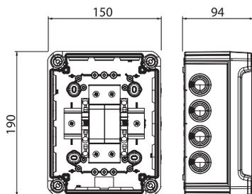
Применение: Молниезащитное уравнивание потенциалов для зданий класса III и IV. При опасности образования конденсата вследствие воздействия ветра, снега, температур, солнца необходимы дополнительные меры защиты!
