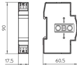
Применение: универсальное применение на профильной монтажной шине 35 мм в обычном корпусе распределителя.
