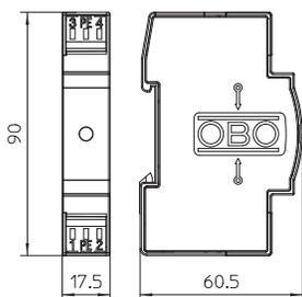
Применение: Универсальное использование на 35мм DIN-рейке в стандартном корпусе распределителя
