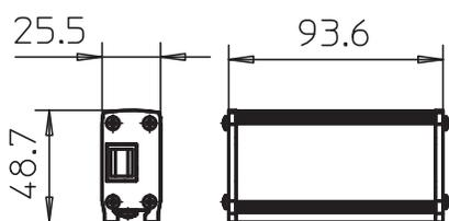
Применение: для защиты сетей 1Гбит-Ethernet, 10/100Мбит-Ethernet, приложения PoE, системы IP-камер, интерфейсы ISDN S0
