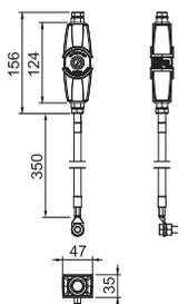
Применение: во взрывоопасных зонах для непрямого соединения изолирующих фланцев и изолирующих винтовых соединений, например, в катодно защищенных установках
