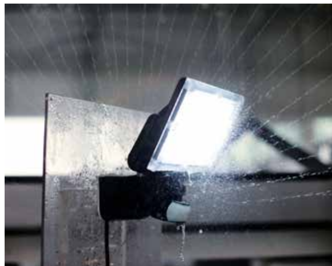
XLED home 1 испытание на прочность: Наше испытание на брызгозащищённость гарантирует погодостойкость и род защиты IP44.
