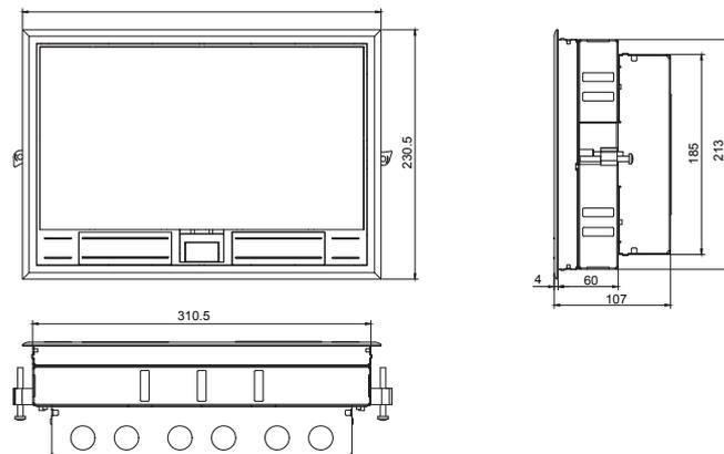
Напольные лючки Donel – решение для организации рабочих мест, как в открытых пространствах типа «Open Space», так и в индивидуальных помещениях и комнатах переговоров, предназначены для монтажа модульных электроустановочных изделий 45x45 в плиты фальш-пола или в бетонный пол.
