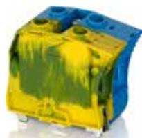
Клеммы защитного проводника с нейтралью (PEN) адаптированы для электросетей TNS и TNC-S за счет комбинации соединения проводов заземления и нейтрали (голубой). Для клемм 10 мм<sup>2</sup> и 16 мм<sup>2</sup> соединение выполняется с помощью безвинтовой перемычки. Для клемм 35 мм<sup>2</sup> соединение осуществляется в рамках заводской сборки.
