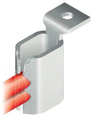
Система ADO System® основана на способе выполнения соединения с прорезанием изоляции (IDC). Способ IDC используется в различных применениях за пределами области электротехники. (Например, разъемы RJ45 используются в области телекоммуникации.) В системе ADO System® используется единственный элемент, который (когда монтируется специальным инструментом) сочетает в себе подготовку провода и выполнение соединения.
