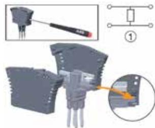
Открыть PG5-R2 плоской отверткой диаметром 3,5 мм.
