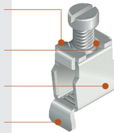
Конструкция предотвращает неправильный ввод кабеля
