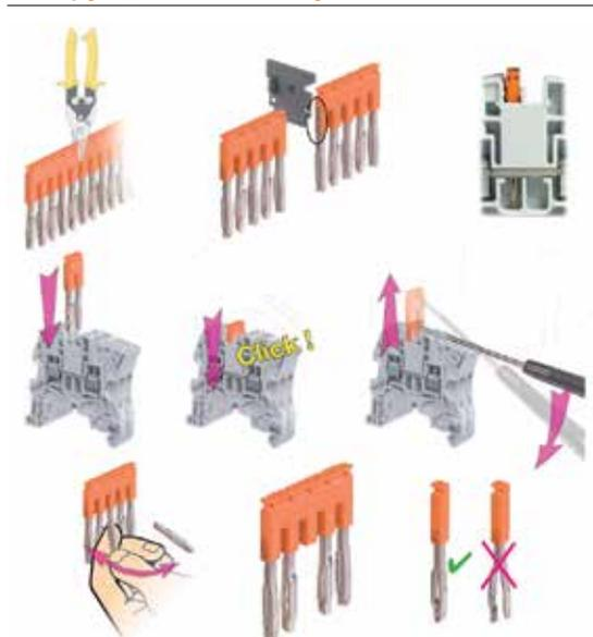
Во взрывоопасных атмосферах использование перемычек с прорезными крайними точками и прорезными промежуточными точками запрещено.
