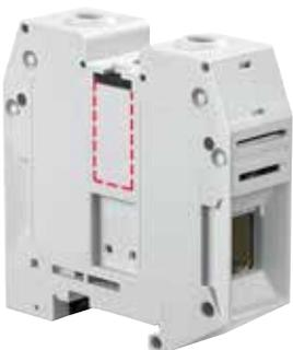
Плоскогубцами убрать перегородки на изолирующем корпусе клеммного соединения. Следить за тем, чтобы не удалить перегородки клемм с перемычками на обоих концах соединения для защиты и изолирования IP20, Nema1.
