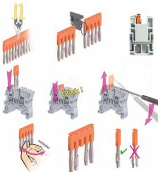
Во взрывоопасных атмосферах использование перемычек с прорезными крайними точками и прорезными промежуточными точками запрещено.
