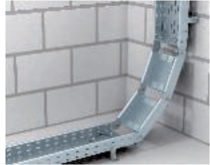
Монтаж восходящего вертикального регулируемого угла Регулируемый угол вертикальный, для соединения участков трассы разной высоты. Регулируемый угол крепится к кабельному лотку с помощью шарнирных соединителей.
