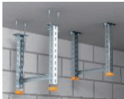
Траверса Монтаж U-образных подвесных стоек US 3 K, US 5 K и US 7 K под потолком с помощью анкерного болта и поперечной траверсы, состоящей из U-образного профиля US 3, US 5 или US 7.
