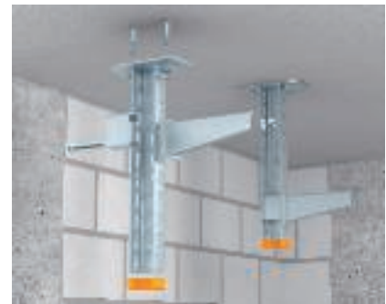
Стандартный монтаж подвесной стойки с настенными и опорными кронштейнами, установленными с одной стороны с распоркой Потолочное крепление подвесной стойки с односторонним монтажом кронштейна. При ширине от 400 мм рекомендуется использовать распорку.
