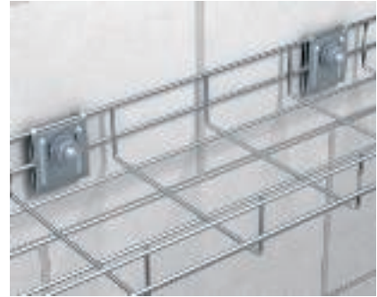
Настенное крепление проволочных лотков Крепление к стене проволочных лотков с помощью настенной скобы K12 1818. Максимальная ширина проволочного лотка 200 мм.
