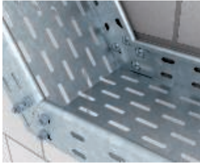
Создание восходящего или нисходящего угла Кабельный лоток необходимо согнуть под нужным углом 0-60 ° и фиксировать продольным соединителем RLVKV 60 FS. Разрез основания профиля не требуется.
