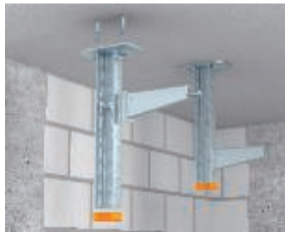
Стандартный монтаж подвесной стойки с настенным кронштейном, установленным с одной стороны без распорки Потолочное крепление подвесной стойки с односторонним монтажом кронштейна. При ширине до 300 мм включительно распорка не требуется.
