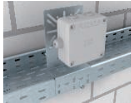
Монтажная пластина с системой быстрого крепления Крепление монтажной пластины MP на кабельном лотке. Монтажную пластину можно зафиксировать на боковой стенке кабельного лотка с помощью комплекта для быстрого соединения, а затем прочно прикрепить болтами FRS B с полукруглой плоской головкой.
