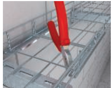
Безболтовое крепление с помощью комплекта для быстрого соединения Продольное соединение проволочных лотков с помощью соединителя GRV без применения болтов.
