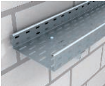
Крепление на кронштейне Крепление кабельного лотка к кронштейну производится с помощью болтов FRS M6x12 с полукруглой плоской головкой.
