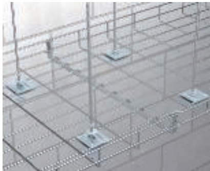
Двойной подвес Крепление проволочного лотка с помощью стержня с резьбой 2078 и настенного/напольного крепления K12 1818. Применяется при ширине лотка от 300 мм.
