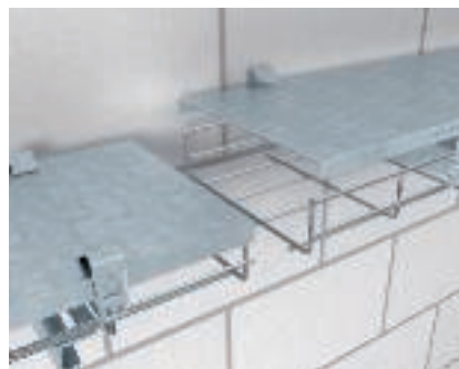
Монтаж крышки Проволочный лоток с крышкой DRLU. Прикрепить крышку к поперечной проволоке лотка с помощью фиксатора DKU.
