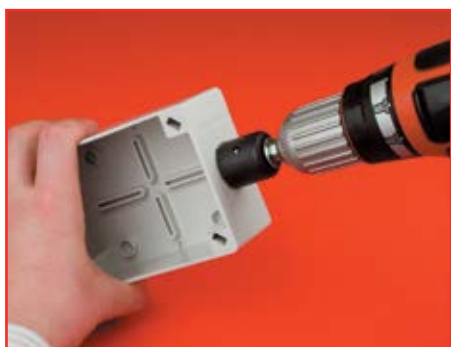
1 этап. Сверлим отверстия необходимого диаметра
