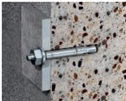
Анкер тип N с резьбой на конце Анкер тип N с резьбой М6, подходит для пористого и непористого бетона от С20/25 до С50/60.
