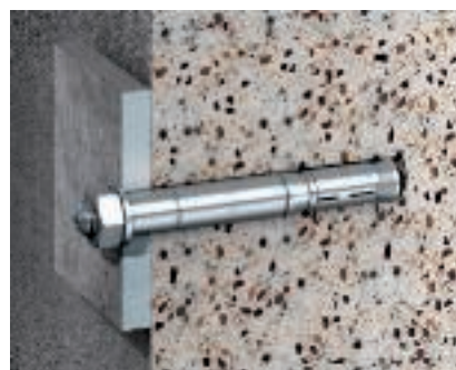
Усиленный анкер тип SZ Усиленный анкер SZ с резьбой М12, для крепления деталей при больших нагрузках, одобрен для пористого и непористого бетона С20/25 до С50/60.
