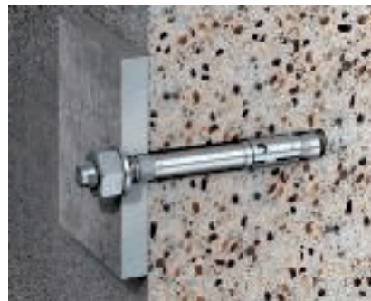
Анкерный болт тип BZ Анкерный болт тип BZ, для крепления высоких нагрузок в пористом и непористом бетоне от С20/25 до С50/60, резьбой на конце М8, М10 или М12.
