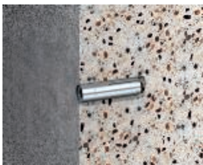
Забивной анкер тип E Забивной анкер тип E с внутренней резьбой М8, М10, М12. Для небольших нагрузок, для многократного применения в пористом и непористом бетоне в ненесущих системах.
