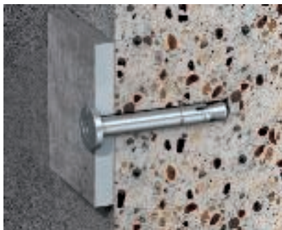
Анкерный болт N-K с забивной головкой Анкер тип N-K с забивной головкой, подходит для пористого и непористого бетона от С20/25 до С50/60.
