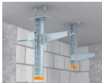
Стандартный монтаж подвесной стойки с настенными и опорными кронштейнами, установленными с одной стороны с распоркой Потолочное крепление подвесной стойки с односторонним монтажом кронштейна. При ширине от 400 мм рекомендуется использовать распорку.
