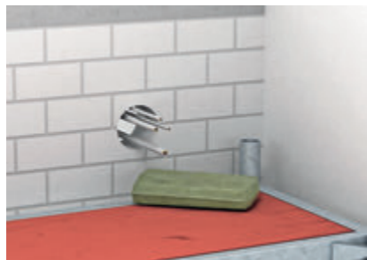
Минеральная вата с точкой плавления \geq 1000 °C для заполнения отверстия.
