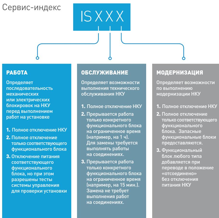
Тип электрических соединений функциональных блоков
