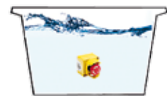
IP67: погружение на глубину до одного метра на 30 минут.
